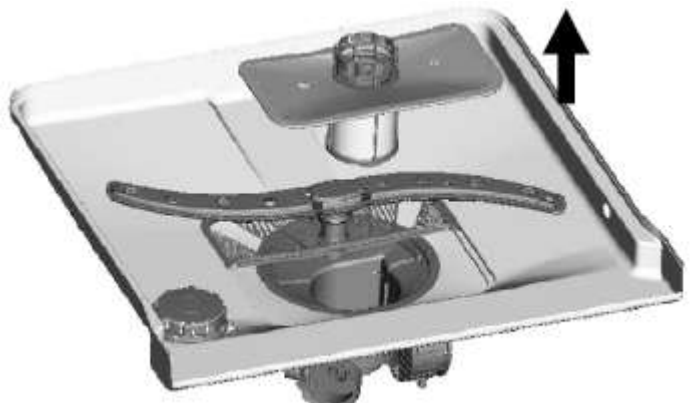
Шаг 2: Выньте фильтр движением вверх
