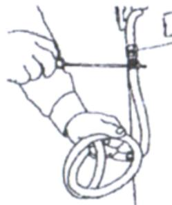
Подсоединение кухонной плиты должно производиться со стороны точки питания таким образом, чтобы шланг не пересекал заднюю панель изделия. При необходимости поменяйте газовый патрубок или попросите представителей сервисного обслуживания адаптировать шланг таким образом, чтобы поступление газа в изделие осуществлялось с правильной стороны.
