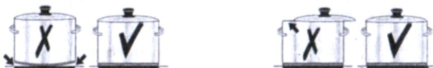
Не используйте емкости с диаметром дна меньше диаметра конфорки.
