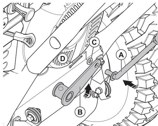
Установите на снегоуборочной машине в отверстие коннектора (В) тягу (А) и закрепите.
