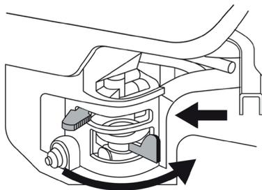
**Примечание!** Для повторного запуска горячего двигателя возможно оставить рычаг воздушной заслонки в положении «ОТКРЫТО».
