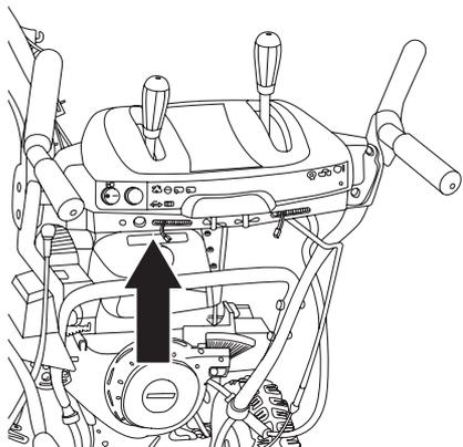
Установите на верхней рукоятке в приемное отверстие рычага переключения передач тягу (А).
