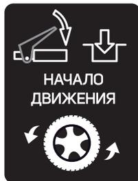
Нажмите на рычаг привода хода по направлению к ручке управления, снегоуборщик начнет движение. Для отключения привода движения отпустите рычаг.
