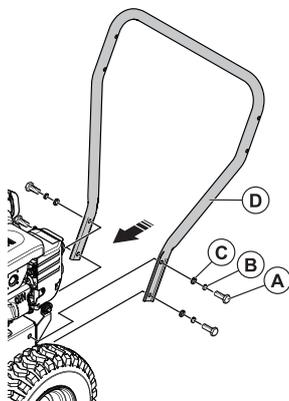
Совместите крепежные отверстия на нижней рукоятке (D) и корпусе снегоуборщика. Затяните с моментом затяжки 25 Нм
