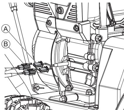
Для комфортного использования снегоуборочной машины она снабжена фонарем освещения и подогревом рукояток. Произведите подключение электрических кабелей (А) (В) через специальные разъемы. Закрепите токоведущую проводку на нижней рукоятке пластиковыми клипсами, для исключения попадания проводов в зону вращения гусениц.
