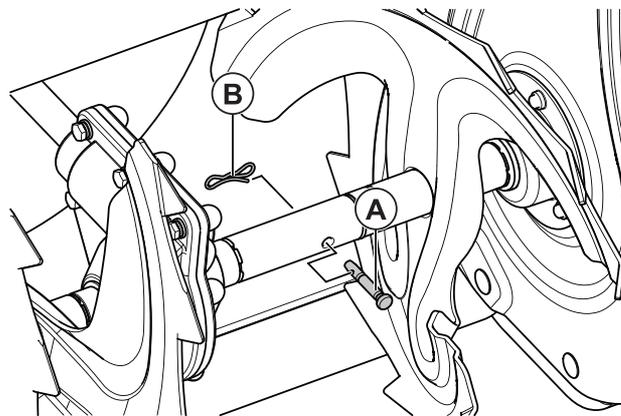
Шнеки крепятся к валу с помощью предохранительных (*срезных*) штифтов со шплинтами или гайками. В случае столкновения шнека с посторонним предметом или ледяным затвором, штифты срезаются и шнек перестает вращаться, предотвращая повреждение других частей снегоуборщика. Если шнеки в момент включения не вращаются, то следует проверить, не срезаны ли штифты. При необходимости замените предохранительные штифты.
