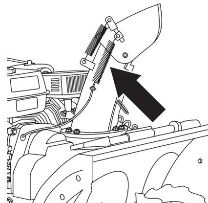
Подключите трос регулировки наклона дефлектора.
