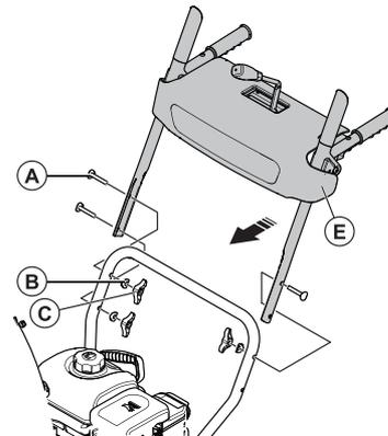
Совместите отверстия нижней и верхней рукояток, и закрепите при помощи болтов и пластиковых барашковых гаек.
