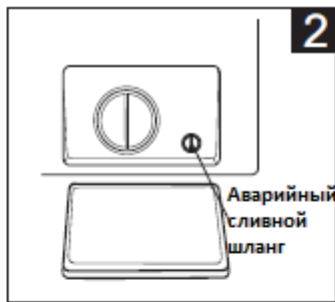
Поверните на 90° и выньте шланг аварийного слива, снимите заглушку шланга
