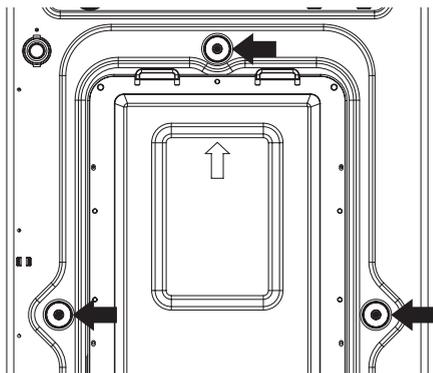
2. Открутите 3 болта 10 мм торцевым гаечным ключом или крестовой отверткой. С охраните болты для дальнейшего использования.
