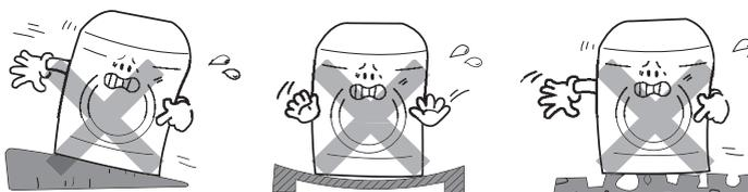
② Выравнивайте положение машины с помощью регулируемых ножек.
