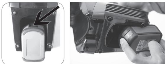
Отсоедините аккумулятор от пылесоса. Для этого нажмите на защелку спереди аккумулятора и потяните его в сторону и вниз.
