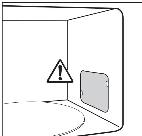
Не удаляйте специальную защитную пластину, расположенную в рабочей камере перед отверстием выхода микроволн, а также пленку с внутренней стороны дверцы.
