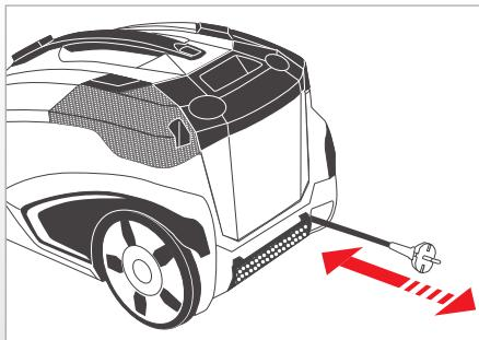
Вынуть вилку из розетки после окончания использования и перед хранением. Слегка потянуть сетевой шнур в сторону от прибора и отпустить его. После этого кабель сматывается автоматически.
