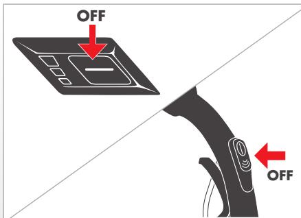
Прибор выключается повторным нажатием кнопки пуска на приборе или на пульте дистанционного управления\*. При повторном включении прибор включается сразу же на ранее выбранный уровень мощности всасывания, если он не был отсоединен от электрической сети.
