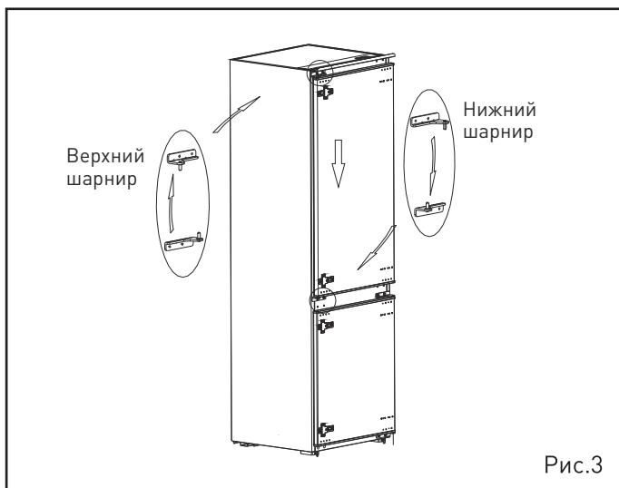
4. Перекрутите крепления для дверной панели на противоположную сторону двери. Установите заглушки.
