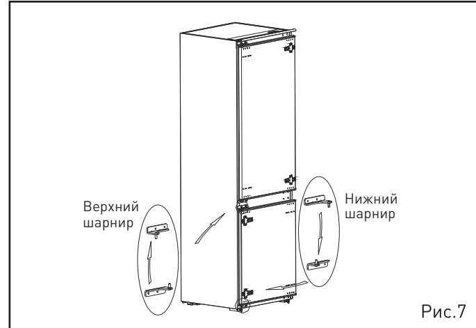
8. Переставьте крепления дверной панели на противоположную сторону двери морозильной камеры. Установите на новое место 2 нижние и 1 верхнюю заглушку.
