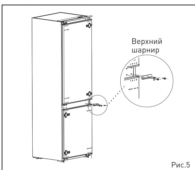
6. Открутите нижний шарнир двери. Снимите 2 заглушки с противоположной стороны.
