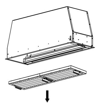
ФИЛЬТР С АКТИВИРОВАННЫМ УГЛЕМ (FCLR AE), С ВОЗМОЖНОСТЬЮ ПРОМЫВКИ И ВОССТАНОВЛЕНИЯ (ОПЦИЯ)
