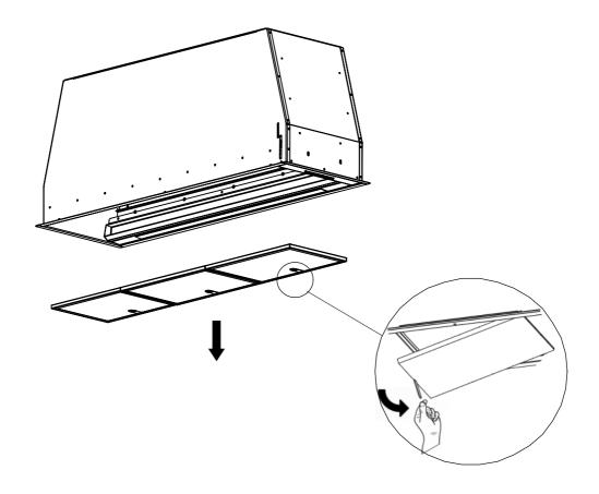
ФИЛЬТР С АКТИВИРОВАННЫМ УГЛЕМ (FCLR AE), С ВОЗМОЖНОСТЬЮ ПРОМЫВКИ И ВОССТАНОВЛЕНИЯ (ОПЦИЯ)
