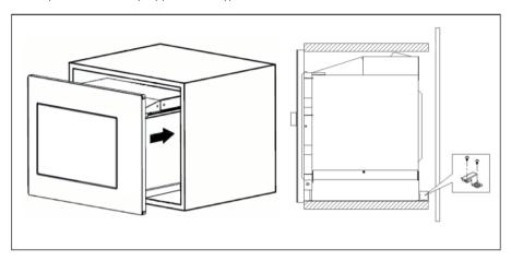
5. Откройте дверцу, прикрепите прибор к шкафу с помощью шурупа, затем установите пластиковую крышку в установочное отверстие.
