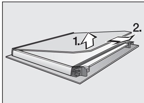
■ **Слегка** приподнимите внутреннее стекло дверцы и извлеките его из пластмассовой планки.
