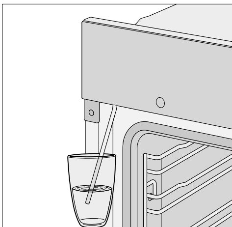
■ Опустите всасывающую трубку в ёмкость с водопроводной водой.
