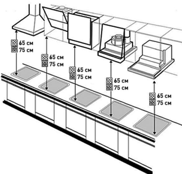
**Расположение:** Расстояние от нижней поверхности вытяжки до поверхности плиты должно составлять минимум 65 см (для электрических плит), 75 см для газовых плит. Если над газовыми будет менее 75 см, может оплавиться фильтр или сама вытяжка
