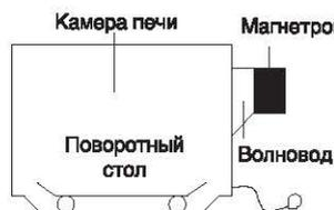
В микроволновой печи электричество преобразовано в микроволну с помощью МАГНЕТРОНА.
