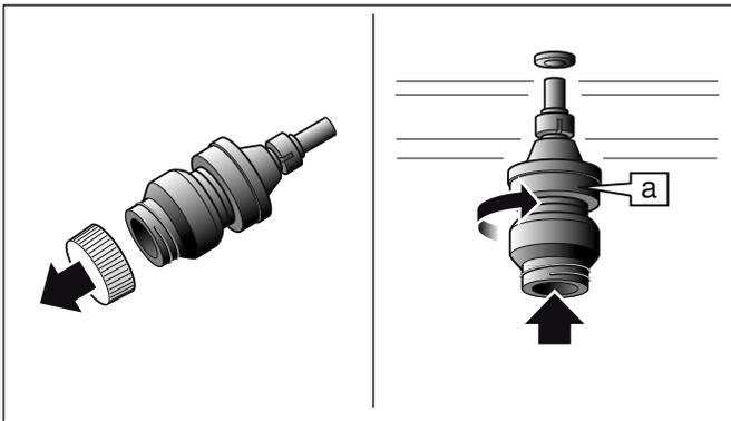
6 Ввинтите чистящий картридж (а) в разъём в верхней части рабочей камеры до упора. Закройте дверцу прибора. Нажмите ✓ для подтверждения. На дисплее отображается время очистки: 3 часа 45 минут.
