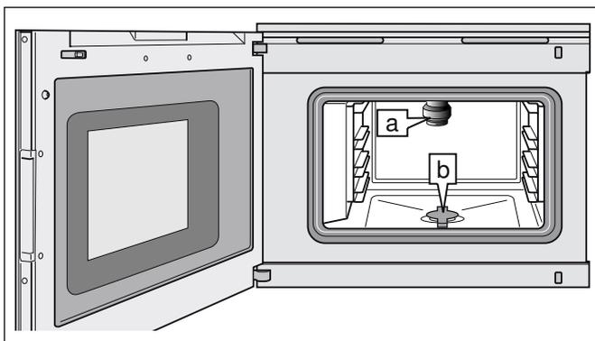
С помощью программы промывки удаляются стойкие загрязнения. Чистящий картридж (a) привинчивается в верхней части рабочей камеры. Рабочая камера очищается, промывается и просушивается автоматически. Сетчатый фильтр (b) во время выполнения программы промывки должен оставаться установленным на дне рабочей камеры.
