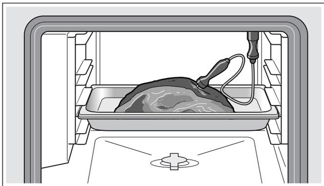
При приготовлении нескольких кусков вставьте проводной термощуп в середину самого толстого куска.
