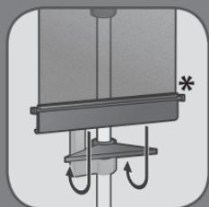
**CZ** Odvříte podpěru, upevněte nastavením prutu pomocí určeného háčku a zajistěte ji.
