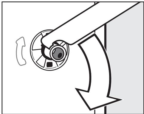
■ Поверните левый транспортиро-вочный стержень прилагаемым гаечным ключом на 90° и
