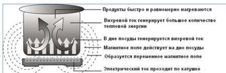
В индукционной плитке используется технология электромагнитной индукции. Электрический ток высокой частоты проходит по катушке, находящейся в плитке, и генерирует переменное магнитное поле. Пронизывая дно посуды, магнитное поле создает в нем вихревые токи, в результате протекания которых непосредственно в дне посуды выделяется большое количество тепловой энергии.
