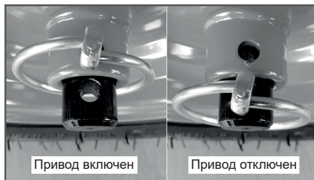
Рис.26 Перестановка шплинта на левом колесе
