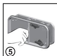
6. Setzen Sie die Wartungsklappe wieder ein.
