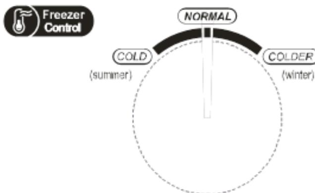
На схеме приведены рекомендованные положения регулятора в зависимости от температуры окружающей среды.
