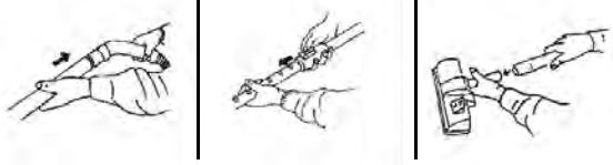
1. Перед началом работы, вытяните сетевой шнур на нужную длину и вставьте вилку в розетку. Не вытягивайте шнур далее КРАСНОЙ метки. Для сматывания сетевого шнура, нажмите кнопку сматывания, придерживая шнур рукой в целях безопасности.
