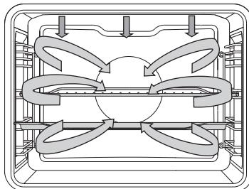
Одновременно работают верхний нагревательный элемент, инфранагреватель и нагревательный элемент вокруг вентилятора. Используется для приготовления всех видов мяса.
