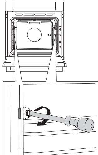
**1** Открутите винт с помощью отвертки.
