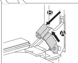
**2** Поднимите фиксаторы дверцы и потяните их на себя.
