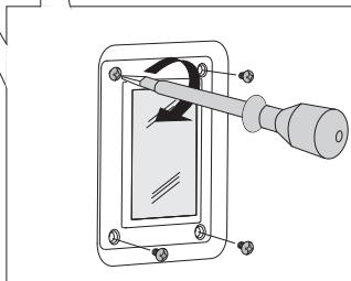
**1** Открутите четыре винта на крышке. Снимите крышку.
