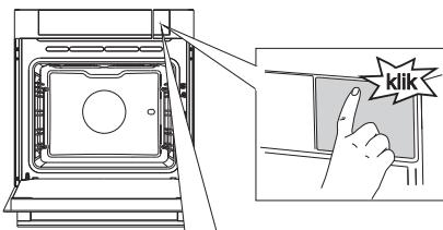
**1** Откройте крышку отсека резервуара, нажав на нее (в области наклейки).
