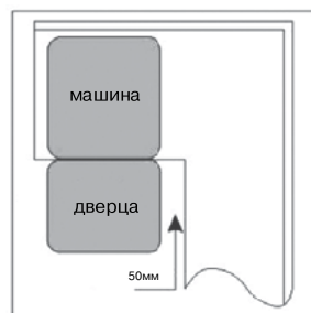
Рис. 2. Вид сверху. Минимальное пространство, когда дверца открыта.
