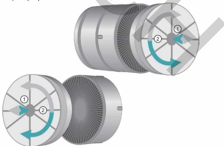
Мал. 14 Усталёўка вугальнага фільтра
