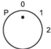
**P** - імпульсний режим роботи (для обробки твердих продуктів)
