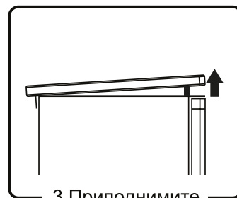
3. Приподнимите верхнюю крышку спереди и установите упор.
