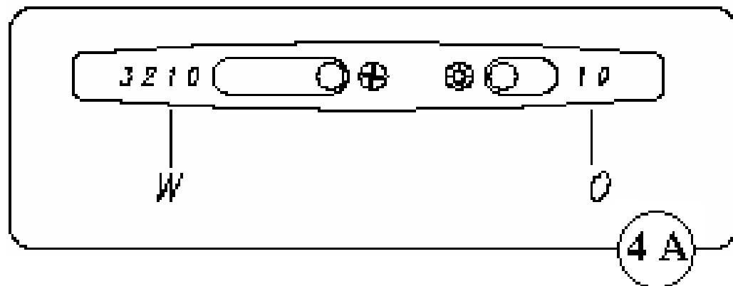
Работа вытяжного устройства контролируется агрегатным переключателем
