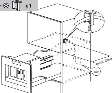
Закрепите шнур питания специальными защелками, чтобы избежать его защемления, когда электроприбор выдвигается или задвигается.
