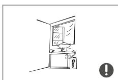
Пожалуйста, перекройте клапан утечки газа, а затем откройте двери и окна в случае утечки газа и других легковоспламеняющихся газообразных веществ. Не отключайте холодильник и другие электроприборы, т.к. искра может вызвать пожар.
