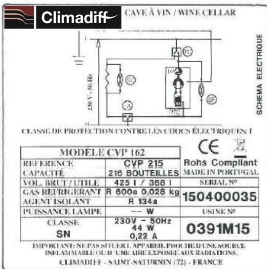
Het typeplaatje dat aan de binnenkant of achterkant van het apparaat (op basis van het model) gekleefd is, bevat alle specifieke informatie over uw wijnkast.
