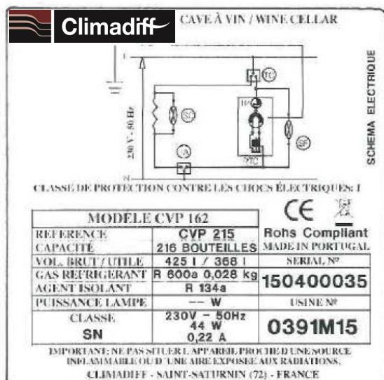
Das Typenschild befindet sich im Geräteinneren bzw. an der Geräterückseite (modellabhängig). Es enthält alle gerätespezifischen Angaben über Ihren Weinschrank.
