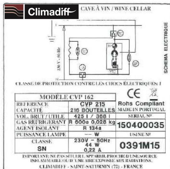
La placa de características pegada en el interior o en la parte posterior del aparato (según el modelo) contiene toda la información específica de la vinoteca.
