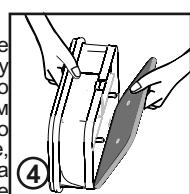
5. Установите переднюю крышку обратно (убедитесь, что она в правильном положении, как указано по стрелке) и нажмите, чтобы крышка встала на свое место. Поверните два фиксирующих рычага по часовой стрелке.
