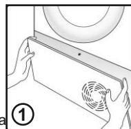
2. Поверните два фиксирующих рычага против часовой стрелки и вытащите переднюю крышку
