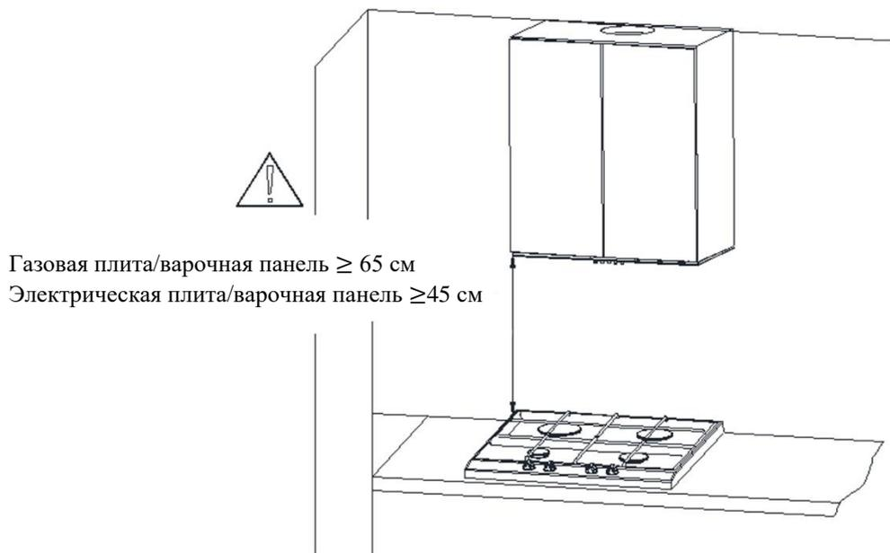
Установка вытяжки показана на рисунках (Рис. 4 – Рис.6). Вытяжка оснащена крепежными штифтами, подходящими для большинства стен и потолков. В процессе сборки соблюдайте общие правила отвода воздуха из помещений.
