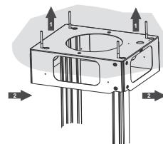
Antes de apertar os parafusos definitivamente é possível fazer ajustes, deslocando a armação, prestando atenção aos parafusos que não podem sair da sede do orifício oval de regulação.
