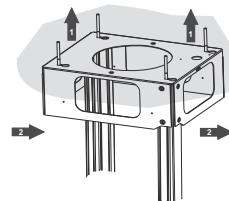
Prima di serrare definitivamente le viti è possibile effettuare delle regolazioni spostando il traliccio, facendo attenzione che le viti non escano dalla sede dell'asola di regolazione.
