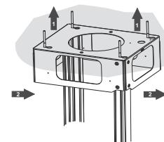
Avant de serrer définitivement les vis, il est possible d'effectuer des réglages, en déplaçant le treillis, tout en contrôlant que les vis ne sortent pas du logement de l'œillet de réglage.
