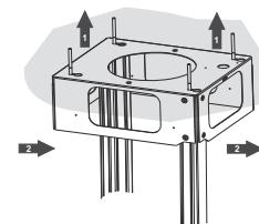
Bevor die Schrauben definitiv festgezogen werden, kann eine Regelung durch Bewegen des Gerüstes erfolgen, wobei darauf zu achten ist, dass die Schrauben nicht aus dem Sitz des Regellangloches austreten.
