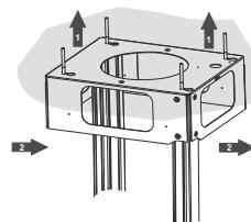
Прежде чем окончательно закрепить винты возможно отрегулировать положение каркаса, смешая его и следя за тем, чтобы винты не вышли из регулировочных петель.
