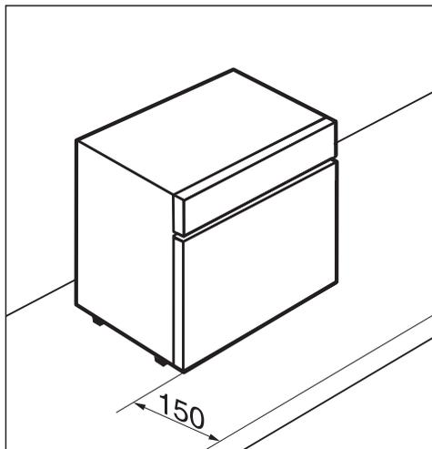
Безопасное расстояние от закрытой дверцы прибора до переднего края столешницы должно составлять не менее 150 мм.
