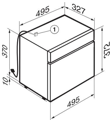
① Место подвода сетевого кабеля к прибору
