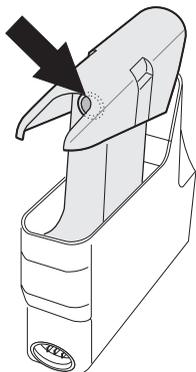
Если после достаточно длительного использования емкость можно будет задвигать и вынимать лишь с усилием (толчками) или появится сообщение об ошибке *F20*, Вам необходимо будет смазать внутри уплотнение на емкости небольшим количеством прилагаемой силиконовой смазки (см. главу "Описание прибора > Принадлежности, входящие в комплект"). Для этого уплотнение не следует вынимать.
