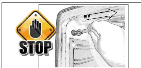
Si el conector se desconecta después del inicio de la cocción, el sistema de control bloquea el horno y avisa del error con señales acústicas: introduzca de nuevo el conector para que la cocción continúe.
