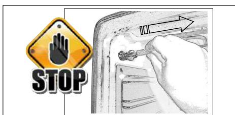
Se lo spinotto viene tolto a cottura iniziata, il controllo blocca il forno e avvisa dell'errore con segnali acustici: reinserirlo per riprendere la cottura!
