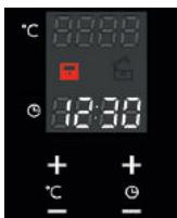
To carregar o símbolo on/off pelo menos durante três segundos para activar ou desactivar, alternativamente, o bloqueio do forno
