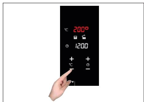
Durante il riscaldamento il simbolo di grado centigrado ( $^\circ\text{C}$ ) lampeggia ad indicare la termoregolazione per raggiungere la temperatura scelta.
