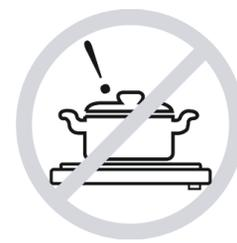
Не используйте варочную поверхность для разогрева кастрюль и сковород без продуктов питания внутри. В противном случае, ее эксплуатационные свойства могут быть нарушены и это приведет к возникновению опасности.
