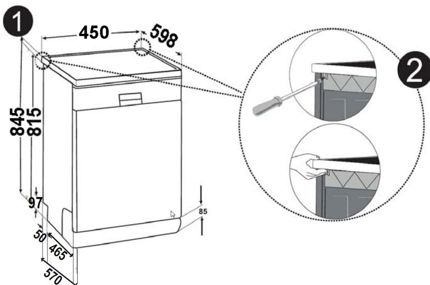
**Внимание.** Стационарная часть, под которую устанавливается машина путем удаления верхней крышки, должна быть устойчивой и не допускать нарушения балансировки.
