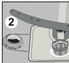
Используйте соль для смягчения, предназначенную специально для посудомоечных машин. Чтобы загрузить соль для смягчения, сначала извлечите нижнюю корзину, затем открутите колпачок отделения для соли, повернув его против часовой стрелки. Сначала заполните отделение 2 килограммами соли и водой до уровня переливания. При наличии воронки ее можно использовать для облегчения наполнения. Установите колпачок на место и завинтите его. После каждого 20-30 моек добавляйте в машину соль (прибл. 1 кг).
