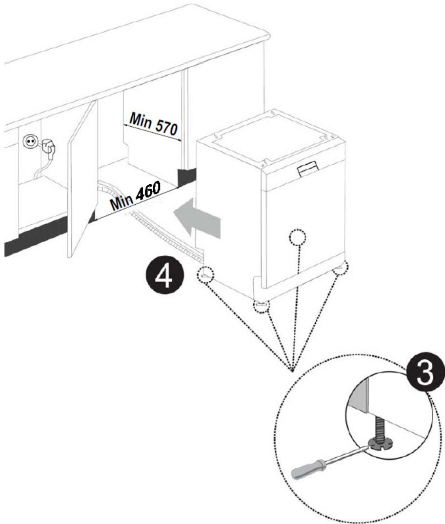
**Внимание.** После снятия верхней панели машину следует поместить в закрытое пространство, допустимые габариты которого показаны на рисунке.
