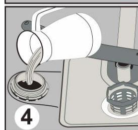
Рекомендуется использовать мелкогранулированную или порошковую соль. Не кладите в машину плиточную соль. Несоблюдение этого условия со временем может привести к ухудшению состояния отсека для смягчителя. При запуске машины отсек для соли заполняется водой. Поэтому добавляйте соль перед запуском машины.
