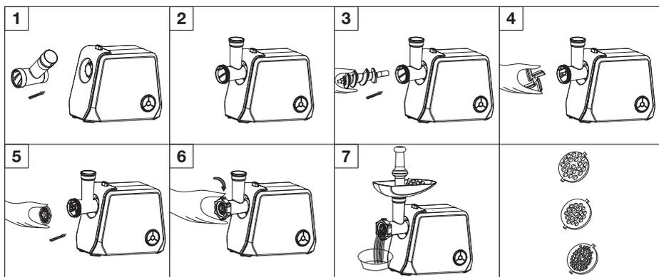
5. Установите нож на шnek. Режущая кромка должна быть развернута в сторону режущего диска (рис. 4).
