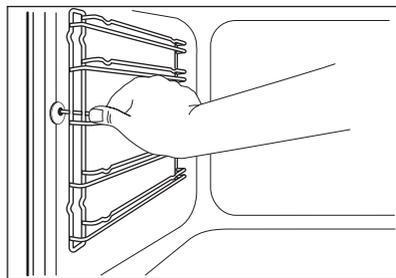
2. Вытяните заднюю часть направляющей для противня из боковой стенки и снимите ее.
