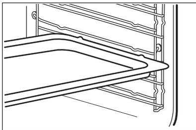
Одновременная установка решетки и глубокого противня:
