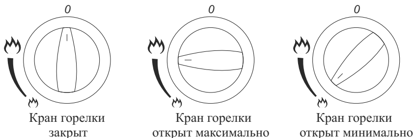
Рисунок 7.1 - Возможные положения ручек кранов газовых горелок.
