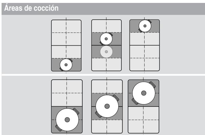
Esto permite desplazar el recipiente a otra área de cocción, con diferente nivel de potencia, durante el proceso de cocción:
