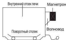
В микроволновой печи электричество преобразуется в микроволны МАГНЕТРОНОМ.
