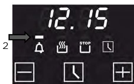
Nach dem das Rückwertszählen beendet ist, ertönen doppelte Signaltöne mit dem Intervall von 2 Sekunden zwei Minuten lang. Nachdem Aufhören des Signaltons blinkt das Symbol Kurzzeitwecker 2 weiter.
