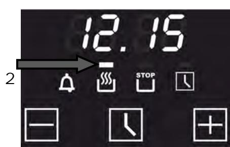
Nachdem das Rückwertszählen beendet ist, ertönen doppelte Signaltöne mit dem Intervall von 2 Sekunden 2 Minuten lang, um Sie zu informieren, dass alle Vorgänge im Backofen abgeschaltet sind. Nach dem Aufhören des Signaltons blinkt das Symbol 2 weiter.
