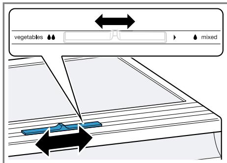
Установка влажности воздуха с помощью регулятора влажности в боксе для фруктов и овощей в зависимости от вида и количества загружаемых продуктов:
