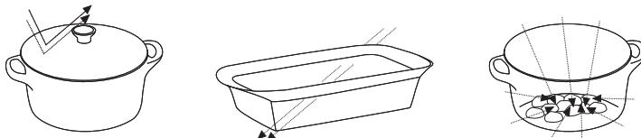
Под воздействием микроволн молекулы начинают двигаться с большой скоростью, создавая молекулярное трение, которое и приводит к нагреванию продукта.
