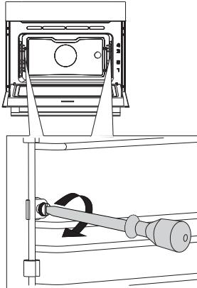
**1** Открутите винты с помощью отвертки.
