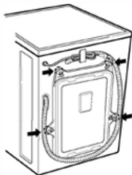
Во избежание повреждений при транспортировке на задней панели установлены 4 болта. Перед использованием стиральной машины демонтируйте болты.
