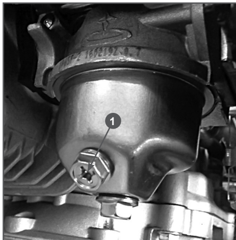
Рис. 23 Слив топлива из карбюратора
