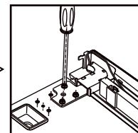
3. Снимите верхнюю дверцу, открутите винт из середины дверной петли при помощи крестовой отвертки, затем снимите нижнюю дверцу.
