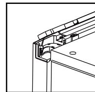
2. Закройте дверь, открутите винт из верхней крышки при помощи крестовой отвертки.
