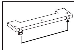
Следуйте инструкции, чтобы снять декоративную крышку. Будьте осторожны, чтобы не испортить ее.
