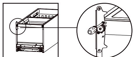
7. Установите нижнюю дверцу, отрегулируйте и зафиксируйте средние дверные петли холодильника.
