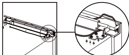
11. Закрепите пластиковую крышку и подключите контакт штепельного разъема
